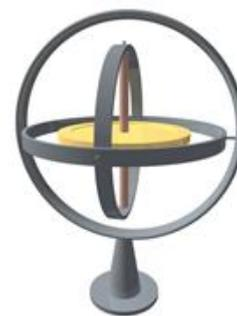
То есть это устройство, которое при любом наклоне предмета, на который установили гироскоп, остаётся в прежнем положении. Оно используется в космических аппаратах, летательных аппаратах, автомобилях – вездеходах, устройствах определения положения в пространстве для видео- и фотокамер и прочего оборудования.
