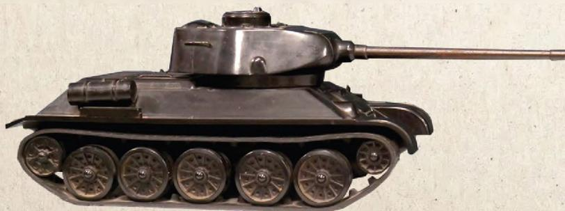
Макет танка Победы Т-34-85 был изготовлен после войны, чтобы отблагодарить тех, кто создавал легендарную машину на Уральском танковом заводе (Уралвагонзавод). Точные копии корпуса, башни и катков изготовлены из эбонита, пушка металлическая, гусеницы прорезиненные. Штампы для отливки созданы умельцами танкового завода, а сами макеты собраны на заводе «Пластмасс» («Уралхимпласт»)
