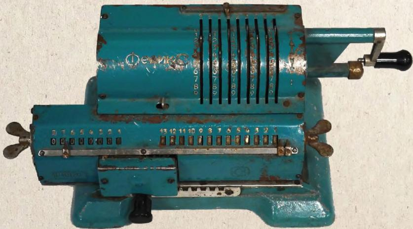
Арифмометр - портативная механическая вычислительная машина, предназначенная для точного умножения и деления, а также для сложения и вычитания. Механическая вычислительная машина, ведущая автоматическую запись обрабатываемых чисел и результатов на особой ленте - арифмограф. Датирована 1960-70 гг.
